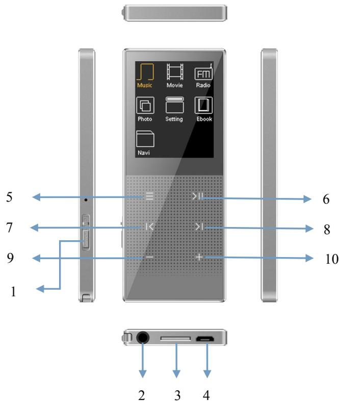
1. Nach oben/unten verschieben, um das Gerät zu sperren/entsperren; gedrückt halten, um das Gerät im gesperrten Zustand einzuschalten.
